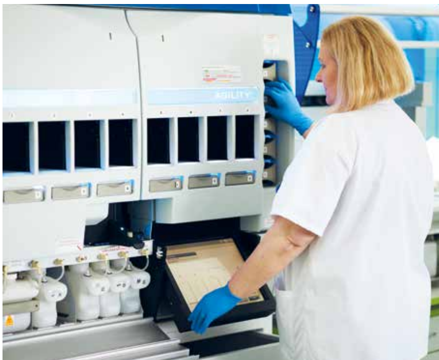
ELISA analyzátor slúži na stanovenie autoprotilátok pri celiakii, pri antifosfolipidovom syndróme a proti kravskému mlieku a bielkovinám kravského mlieka.
